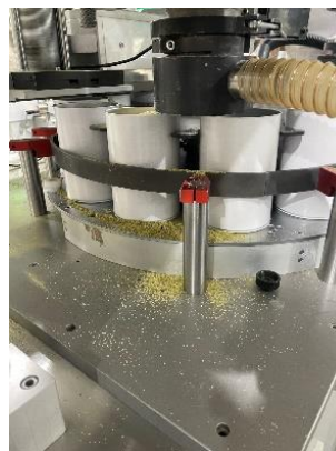
Bild 2: Unsaubere Dosierung führt zu Produktverlust (Anwendung B)
