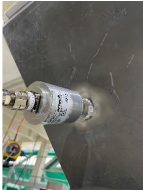
Bild 3: Ultraschallkonverter am Aluminiumtrichter
