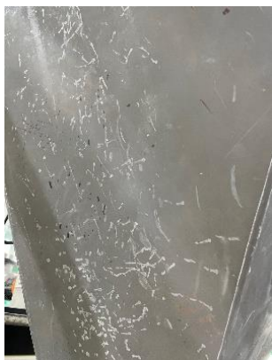
Bild 1: Auswirkungen der Hammerschläge am Trichter (Anwendung A)
